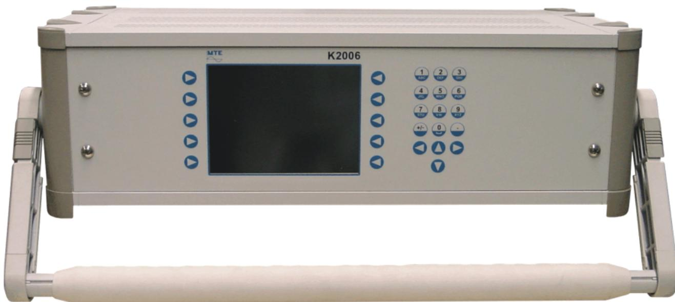
К 2006 – это 3-фазный компаратор, который был специально разработан для применения в универсальных и испытательных лабораториях. Он предназначен для проверки и калибровки образцовых счетчиков электроэнергии и мощности, для калибровки высокоточных источников тока и напряжения и для поверки установок для проверки и поверки счетчиков электроэнергии.
