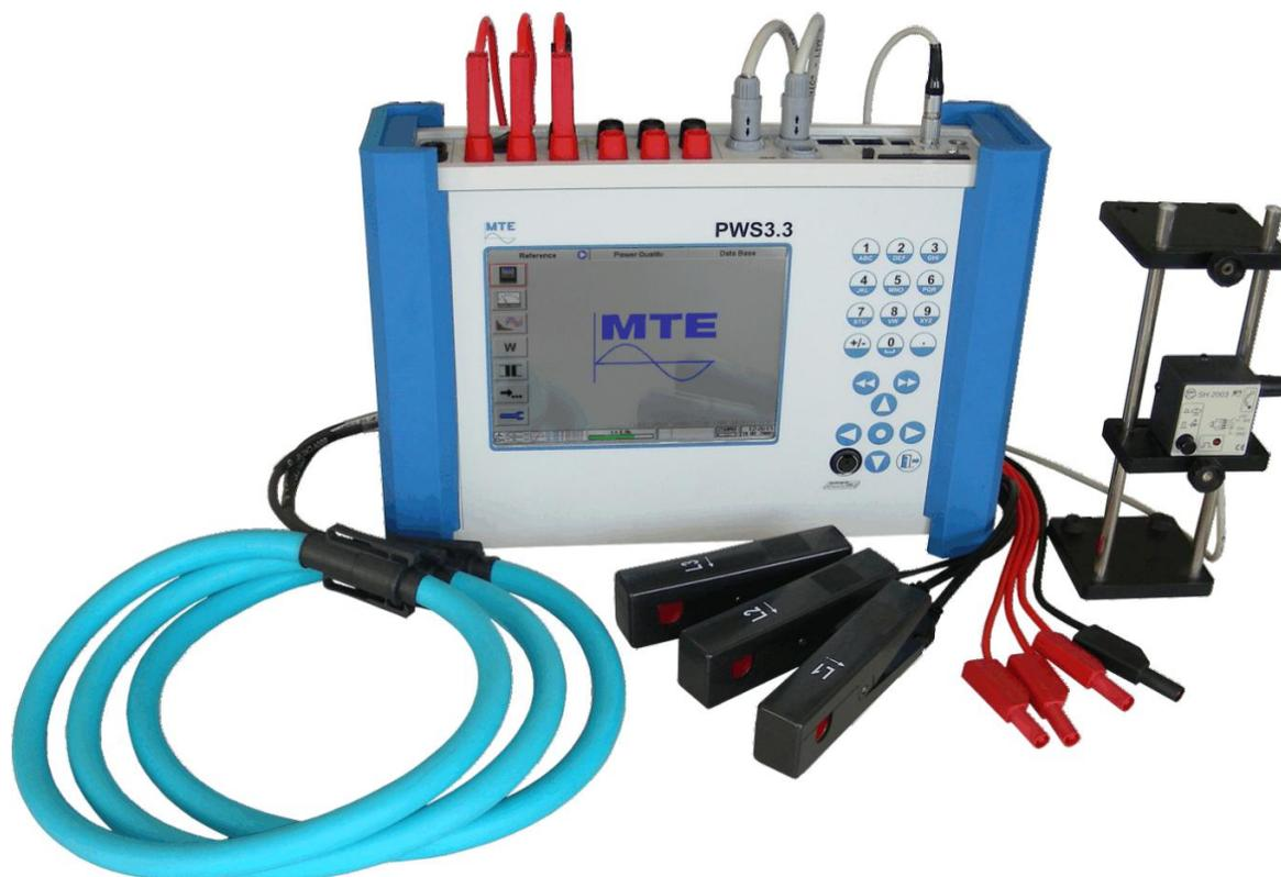
PWS 3.3 – это прибор, сочетающий в себе образцовый трехфазный портативный счетчик класса точности 0,05% или 0,1% и анализатор качества электрической энергии, соответствующий стандарту МЭК 61000-4-30 класса А с 3-мя каналами измерения по напряжению и 4-мя каналами по току.
